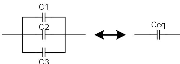
La capacité équivalente à un groupement de condensateurs en parallèle est égale à la somme des capacités des différents condensateurs :
